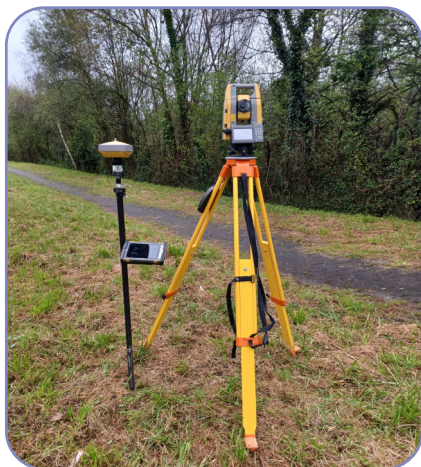
TOPCON GT-1003+FC 5000 (Tecnología de posicionamiento híbrido)
